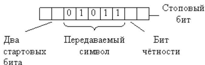
Рис. 50. Асинхронная передача данных
