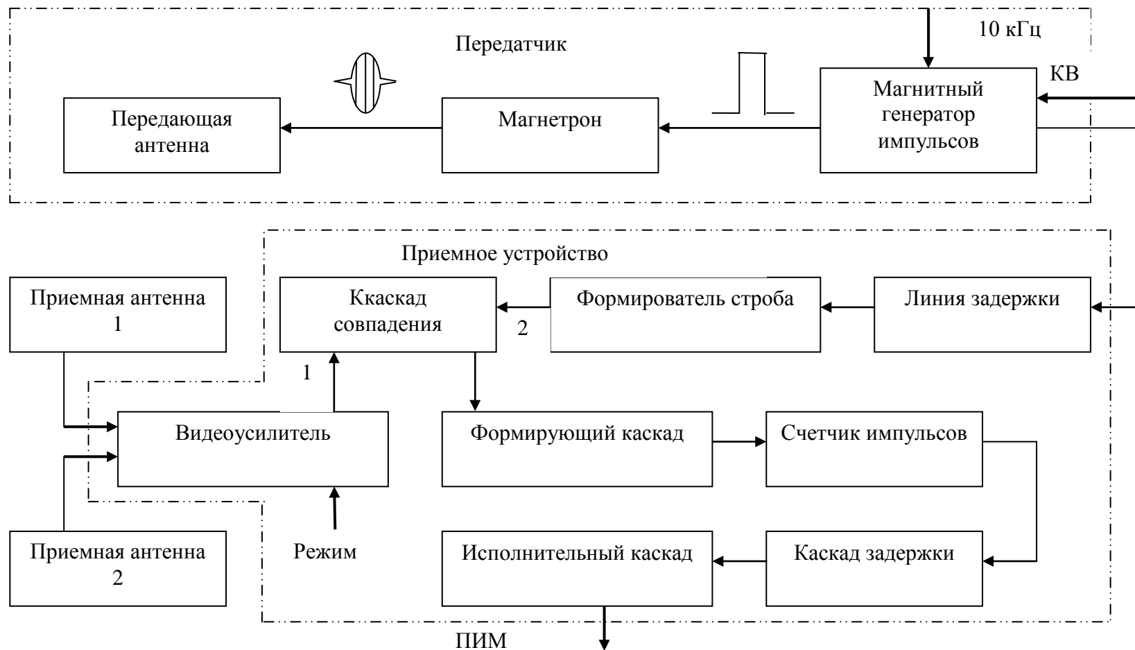
Рис. 31. Функциональная схема РВ
