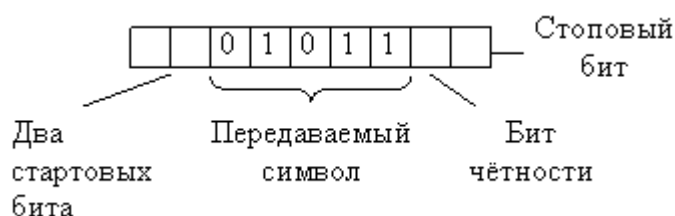
Рис. 51. Синхронная передача данных
