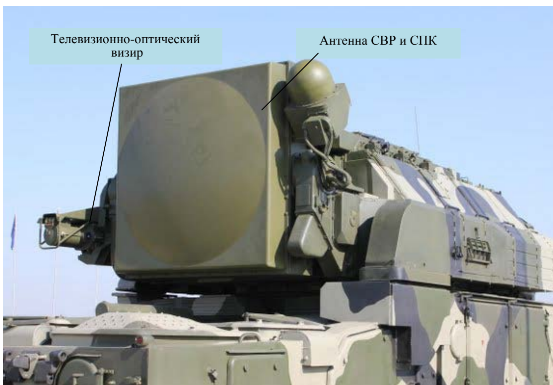
Рис. 5. Станция сопровождения целей и наведения ракет (СВР и СПК) и дублирующий телевизионно-оптический визир
